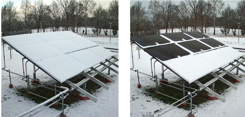
Abbildung 14: Schneeabschmelzen (untere Module nicht angeschlossen | 14.02.25 | Ottendorf-Okrilla)
