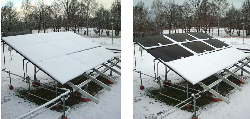
Abbildung 14: Schneeabschmelzen (untere Module nicht angeschlossen | 14.02.25 | Ottendorf-Okrilla)
